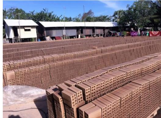
L'aire de séchage des briques avant leur acheminement vers les fours de cuisson et au fond, on voit quelques logements pour les ouvriers.
